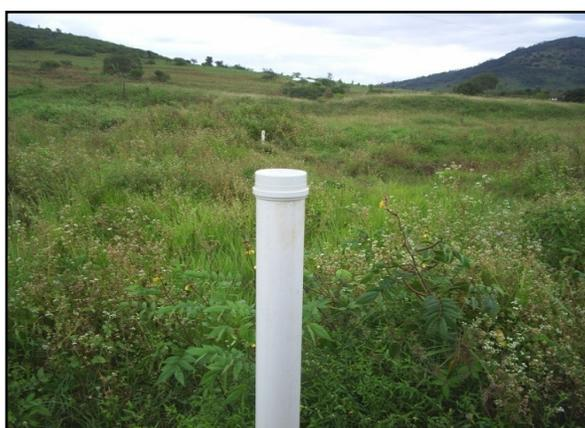
Figura 18: Piezômetros da sub-bacia
