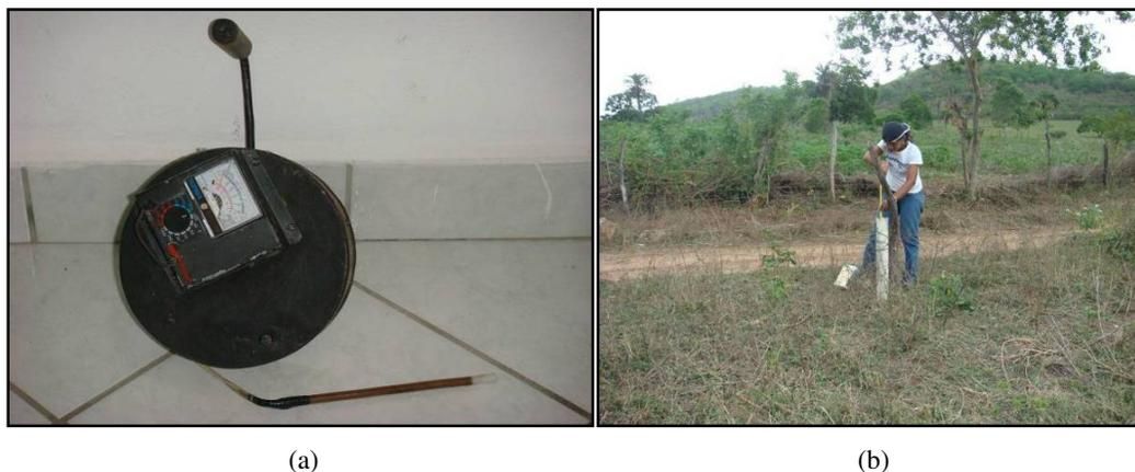
Figura 28: (a) Sensor de nível confeccionado para (b) Medição nos piezômetros
