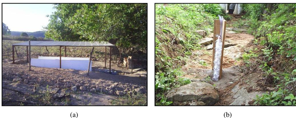
Figura 20: (a) Fossa de sedimentos e (b) Amostrador de sedimentos de nível ascendente
