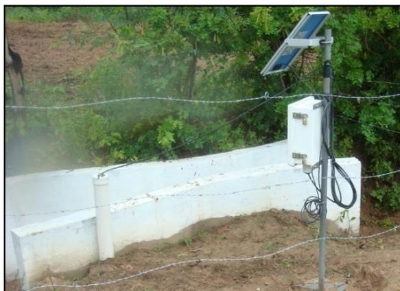
Figura 17: Calha Parshall e linígrafo da sub-bacia
