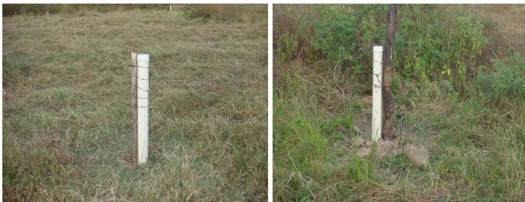
Figura 27: Proteção dos piezômetros
