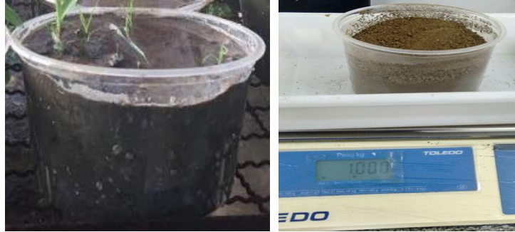
Figura 2. Vaso de 1L com 1 Kg de substrato peneirado e em sua capacidade de campo.
