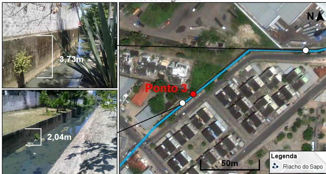
A Figura 35 apresenta o perfil longitudinal do riacho do Sapo no ponto crítico de alagamento 3 modelado no SWMM. Nota-se a redução considerável na profundidade máxima do canal citada anteriormente. Desta forma, durante as simulações, observou-se que a profundidade máxima do canal (Cond-30) foi superada durante eventos pluviométricos recorrentes, como uma chuva com tempo de retorno de 5 anos (Figura 35).
