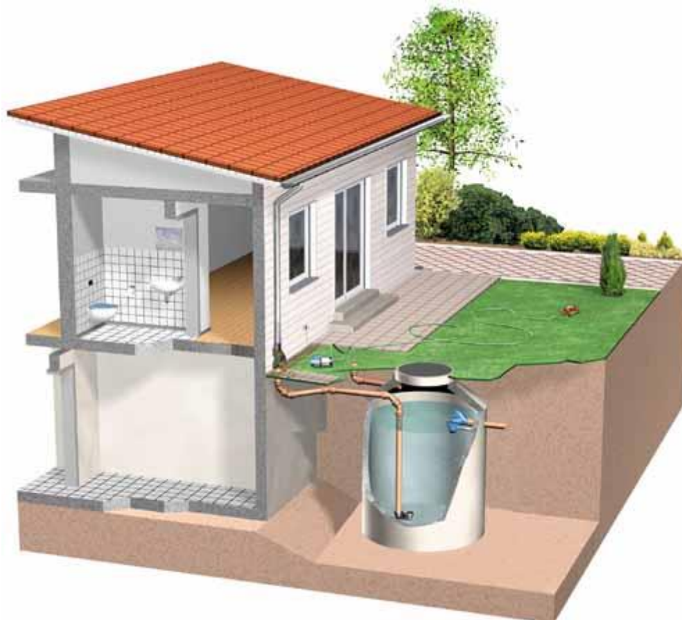
Figura 2.6 – Ilustração de um sistema de reuso de água das chuvas.
