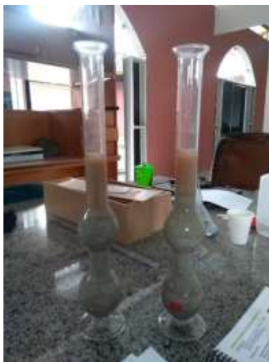
Figura 13: Determinação da Massa Específica pelo frasco de Le Chatelier
