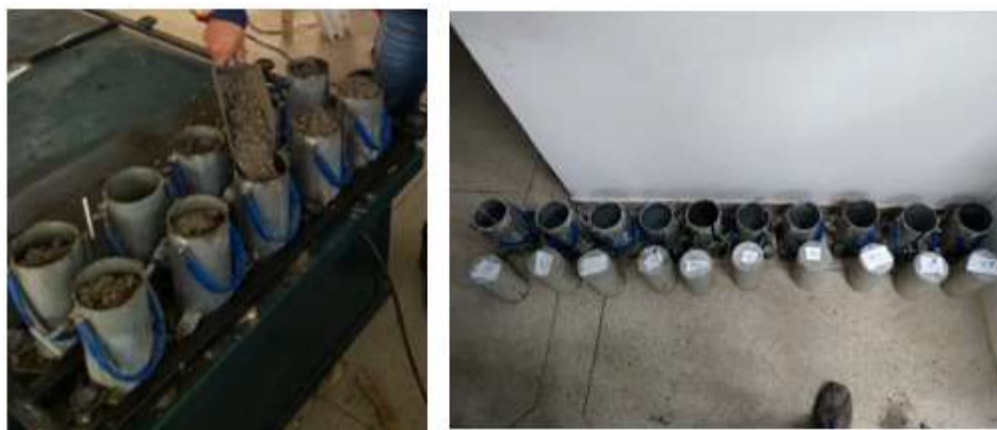
Figura 16; Molde e Desmolde dos CP's
