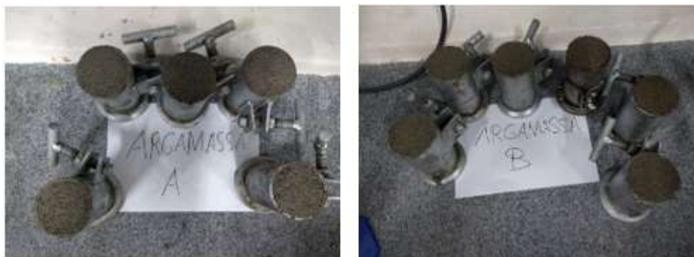
Figura 14: Moldagem dos CP's de Argamassas
