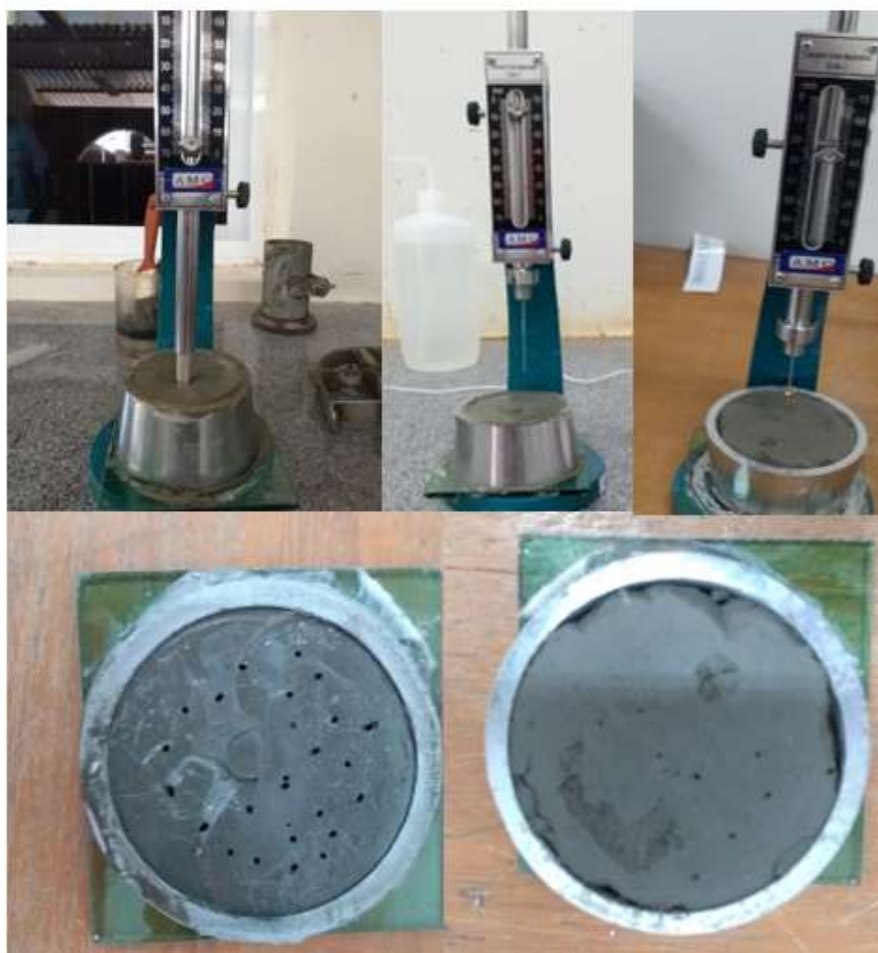
Figura 11: Ensaio de Tempo de Pega
