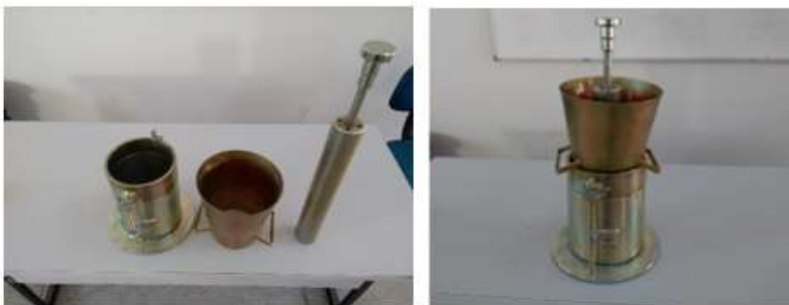
Figura 12: Estrutura Montada para Moagem
