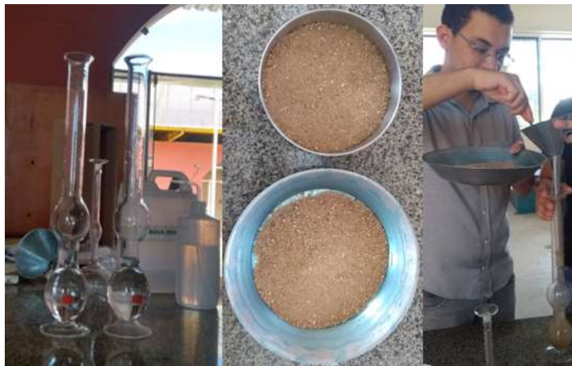
Figura 10: Ensaio de Densidade da Areia
