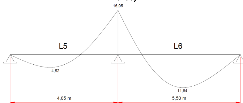
Figura B.38 – Momentos fletores característicos compatibilizados – Lajes L5–L6 (Tabela de Bares)
