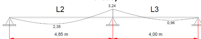
Figura B.6 – Momentos fletores característicos compatibilizados – Lajes L2–L3 (Tabela de Marcus)
