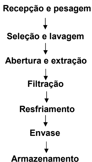
Figura 1: Etapas de preparação de água-de-coco resfriada
