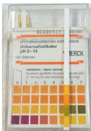
Figura 23 – Avaliação do pH utilizando papel indicador de pH MERCK
