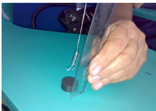
Figura 8 - Medindo a distância da força de atração magnética
