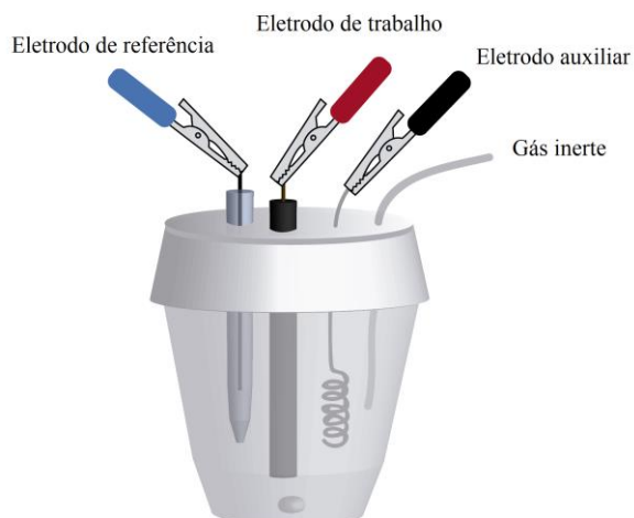
Figura 14 - Sistema com os três eletrodos para análises eletroquímicas.
