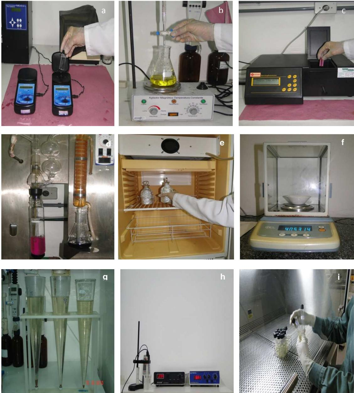
( a ) Cor e Turbidez; ( b ) Titulação – Cloreto, OD e DBO; ( c ) Espectrofotometria  $\text{NO}_2^-$ ,  $\text{NO}_3^-$  e  $\text{P}_{\text{total}}$ ; ( d ) Destilação – N amoniacal; ( e ) Incubação - DBO; ( f ) Gravimetria - ST e SDT; ( g ) Cone de Inhoff – S.S; ( h ) pH e C.E; ( i ) coliformes.
