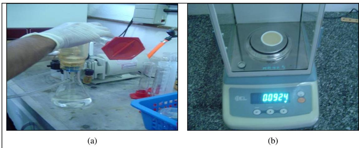
Figura 22 – Etapas da análise laboratorial: (a) Processo de filtragem da amostra com o auxílio de uma bomba de vácuo; e (b) Pesagem da membrana filtrante utilizando balança de precisão.
