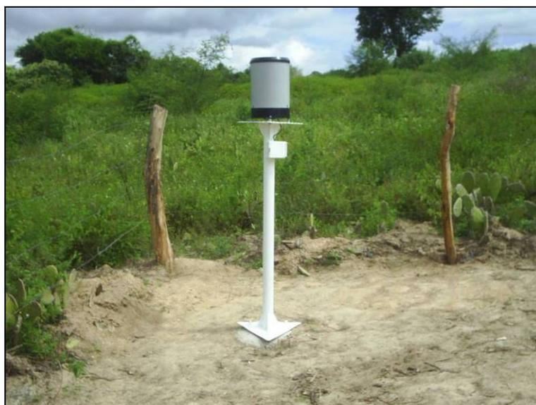
Figura 19 – Pluviógrafo CS700 (CAMPBELL SCIENTIFIC) instalado nas proximidades da microbacia.
