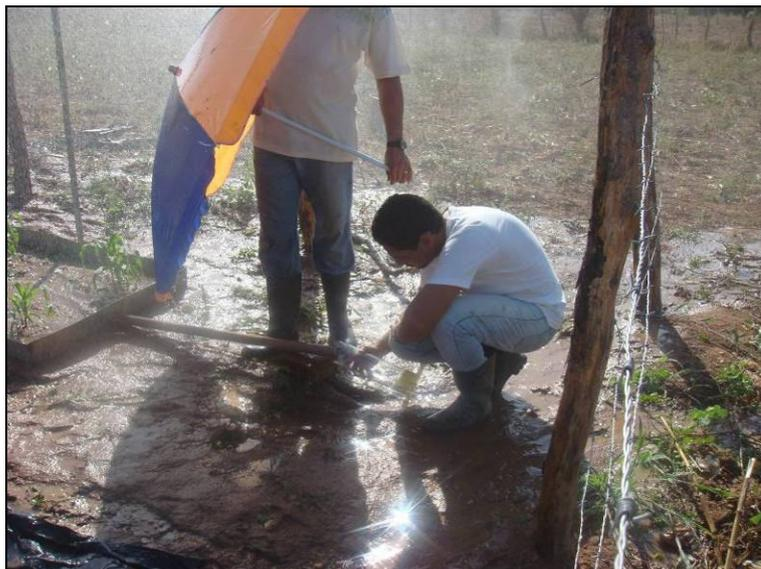
Figura 28 – Amostragem em parcela experimental de erosão na bacia experimental do riacho Gravatá.
