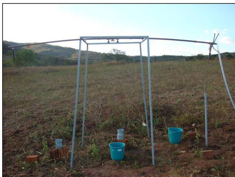
Figura 24 – Configuração utilizada durante o processo de calibração do simulador de chuva.
