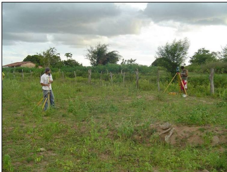
Figura 13 – Levantamento topográfico da microbacia na Bacia Experimental.
