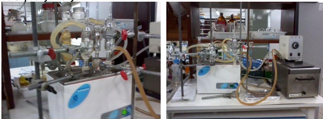
Figura 60 – Aparelhagem para extração, em ultrassom, do ácido tormêntico em raízes de C. pachystachya .
