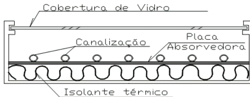
Figura 15 – Seção típica de um coletor de superfície plana. Fonte: LIMA, 2003
