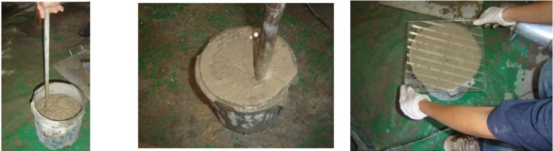
Ilustração 26 – Execução do ensaio de teor de ar.
