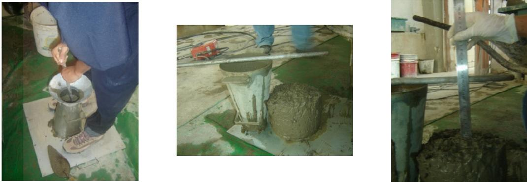
Ilustração 25 – Execução do ensaio de abatimento.
