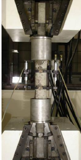
Ilustração 9 – Ensaio de resistência à tração direta (FURNAS-COPPE), para amostras cilíndricas (VELASCO, 2008).
