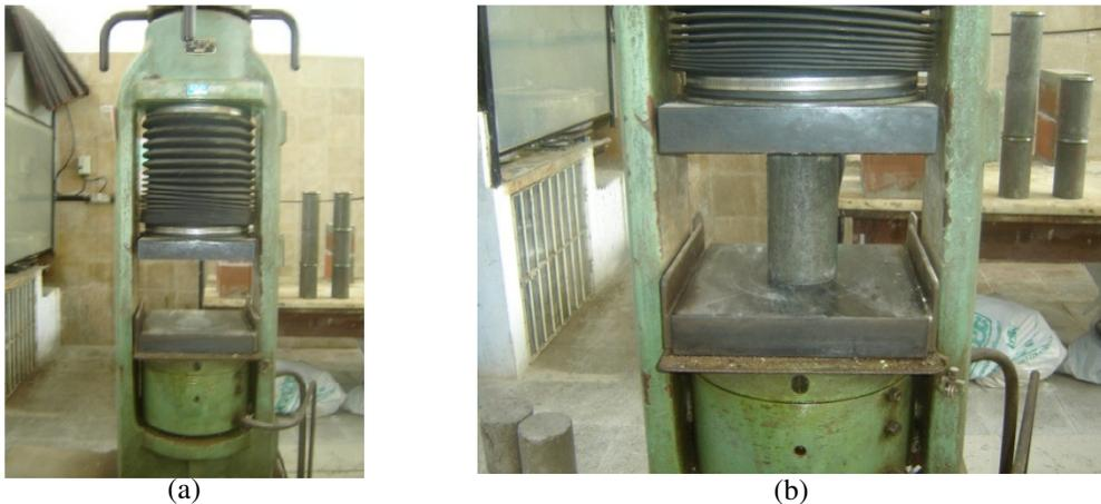
Ilustração 28 – (a) Prensa AMSLER de 200 tf; (b) Execução do ensaio de resistência à compressão
