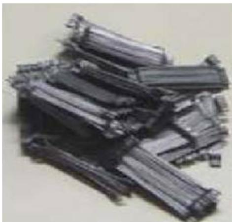
Ilustração 5 - Fibras de Aço (RESENDE, 2003).
