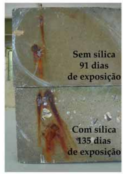
Figura 38 – Manchas de corrosão em placas com e sem sílica.
