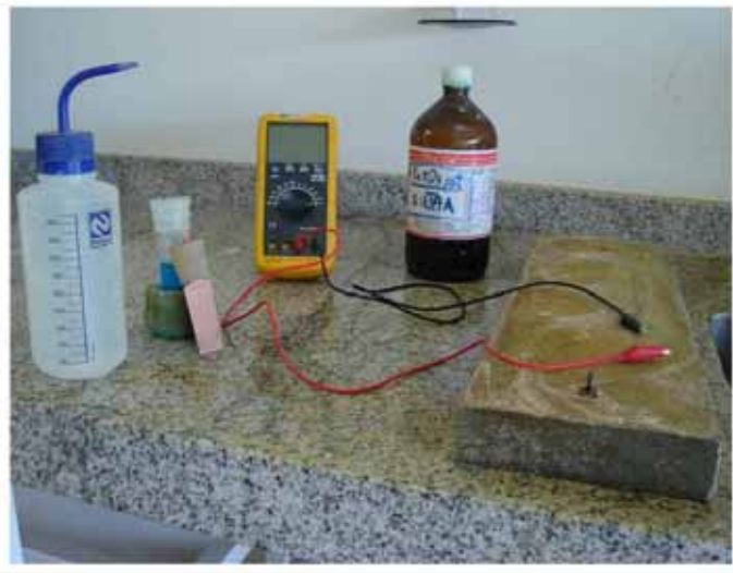
Figura 19 – Equipamentos e materiais empregados no ensaio de potencial de corrosão.
