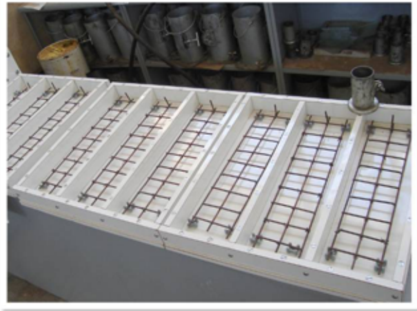
Figura 16 – Fôrmas para moldagem das placas.
