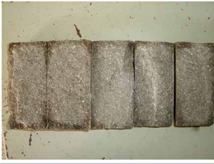
Figura 32 – Corpos de prova com sílica aos 135 dias, rompidos à tração.
