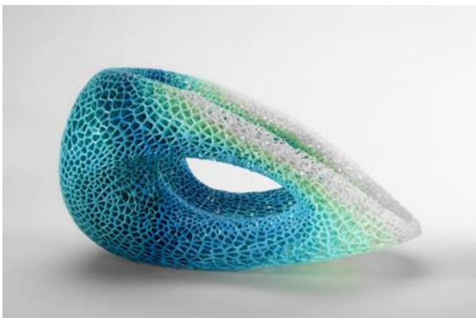
Figura 119 - Imprimindo com propriedades materiais graduais (HUANG, 2016)
