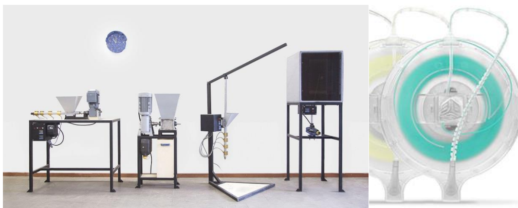
Figura 122 - a) Microestação de reciclagem de plásticos para impressão precious plastic (HAKKENS , 2016) b) Filamento para FDM (3D SYSTEMS, 2016)
