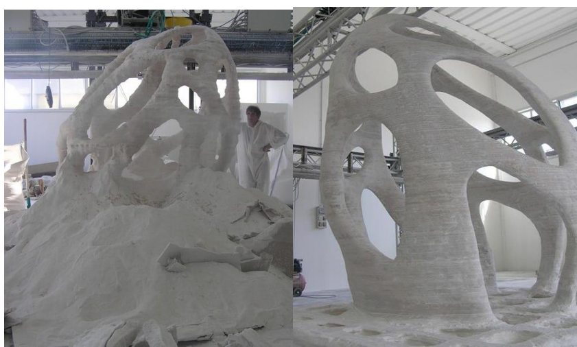
Figura 55 - Objeto Radiolaria antes e depois de retirado o suporte de cama de areia (DINI, 2009)
