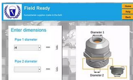
Figura 109 – Interface do aplicativo para customização de peças hidráulicas sob demanda para conectar tubos de diferentes diâmetros (FIELD READY, 2015)
