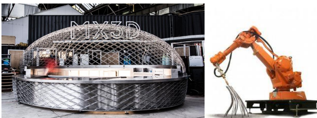
Figura 57 - a) Impressão por solda (MX3D, 2015) b) impressão com braço robótico (LAARMAN, 2013)
