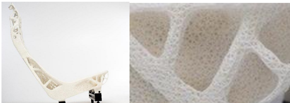
Figura 65 - Otimização de topologia para peças de veículos (TOYOTA, 2015)
