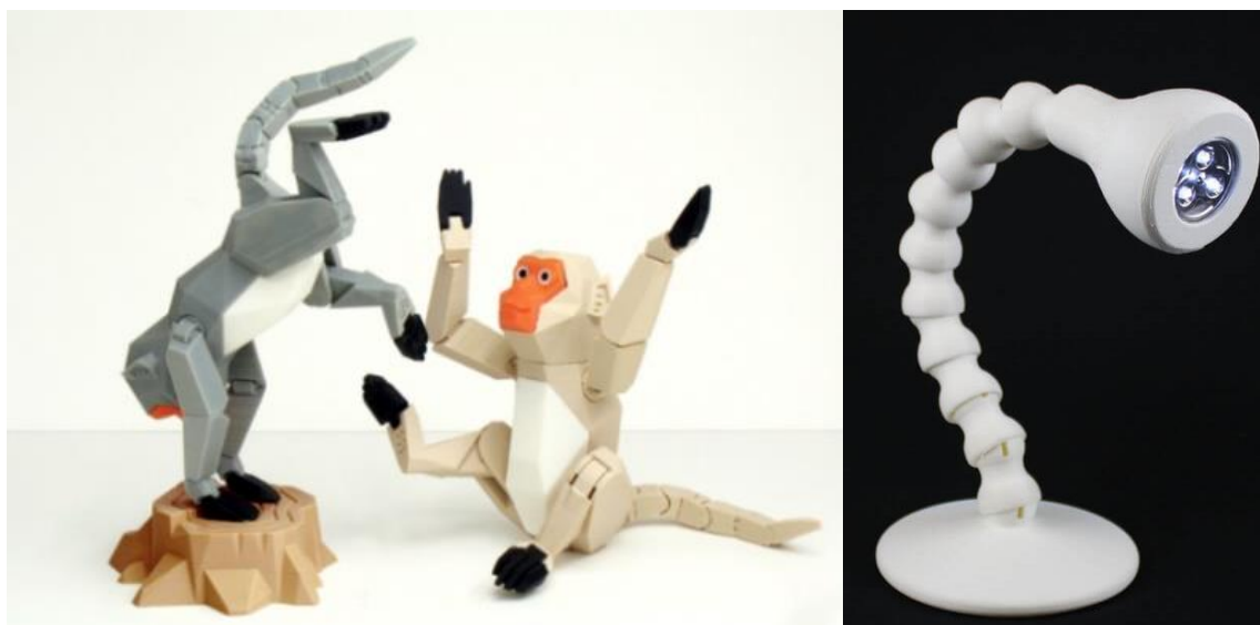
Figura 105 - Objetos articulados impressos sem necessidade de montagem (THINGVERSE, 2015)
