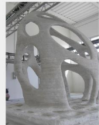
Radiolaria de Andrea Morgante Por D-Shape CAD-CAM 24 horas para curar
