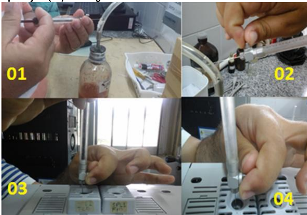
Figura 05 - Coleta (01), Travamento (02), Destravamento (03) e Aplicação (04) do biogás.
