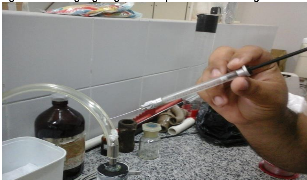
Figura 04 - Seringa “gastight” usada para a coleta do biogás.
