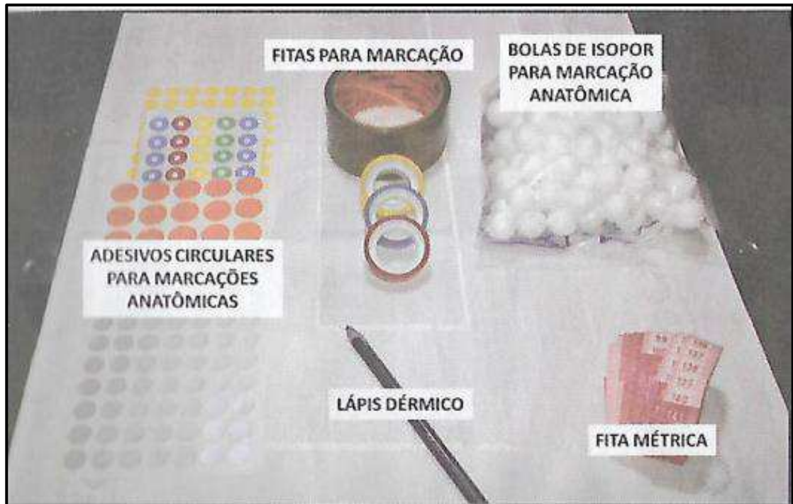
Figura 3 - Objetos ou marcadores para uso da fotogrametria
