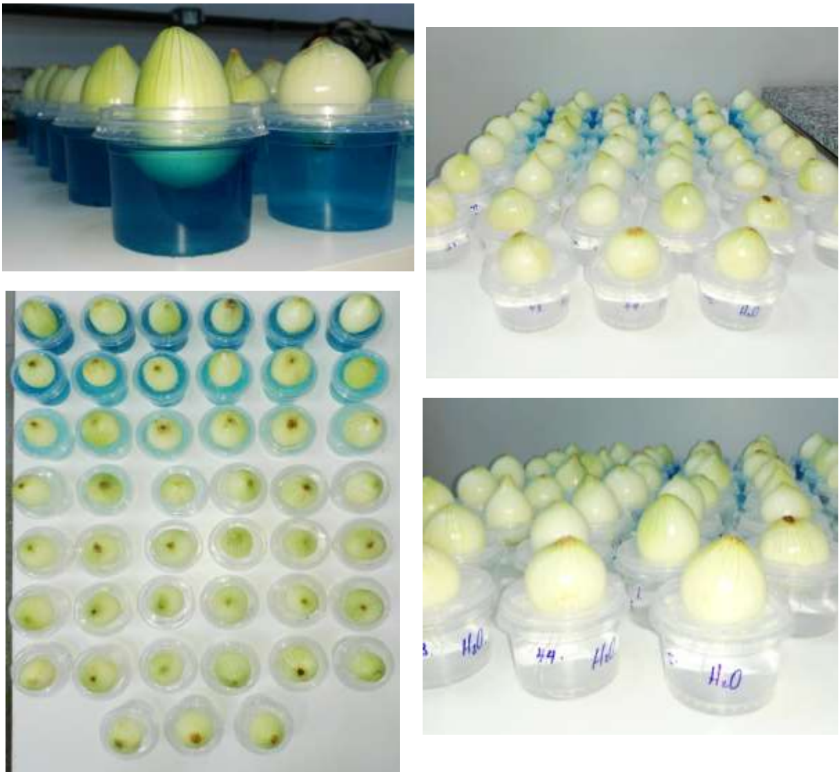
Figura 16 - Esquema do teste de fitotoxicidade aguda com o bioindicador Allium cepa L. (Cebola). Efluente tratado e não tratado
