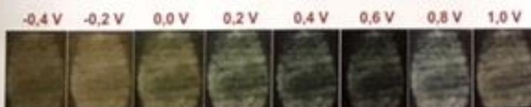
**Figura 3:** Imagens das impressões digitais reveladas após a deposição eletroquímica de polianilina sobre uma superfície de aço inoxidável em função do potencial elétrico aplicado ao sistema.
