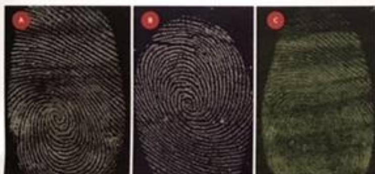
**Figura 2:** Imagens das impressões digitais reveladas a partir da deposição eletroquímica de: a) polipirrol, b) PEDOT e c) polianilina, sobre uma superfície de aço inoxidável.
