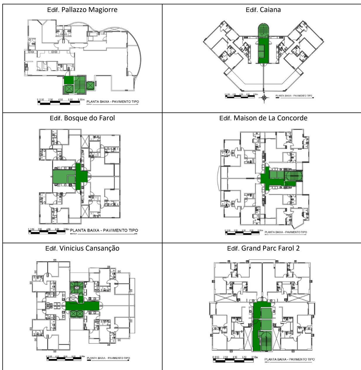
Figura 78 - Circulação centralizada exteriorizada
