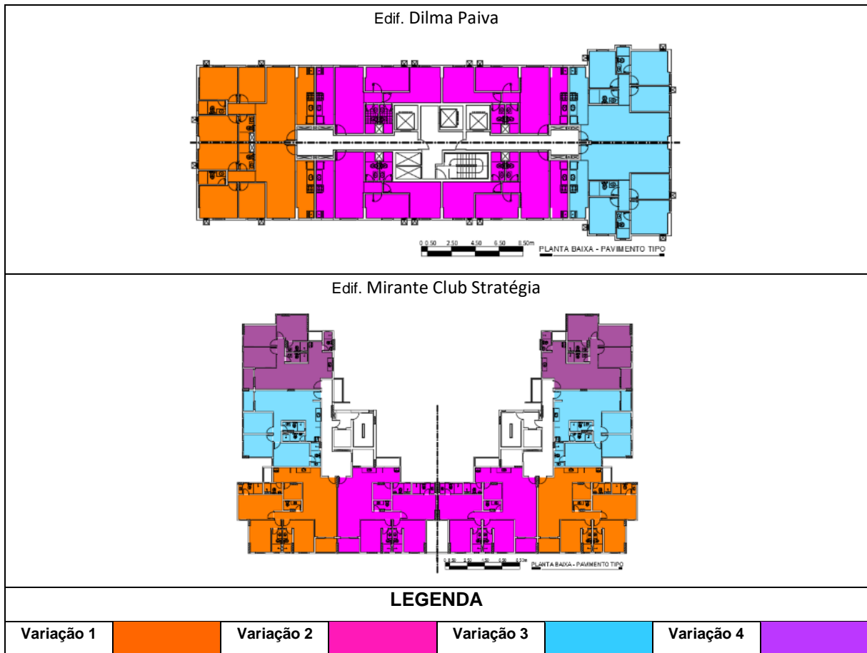
Figura 77 - Configuração do pavimento tipo – 8 unidades
