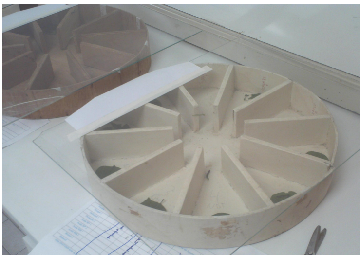
Figura 3. Arenas para teste de livre escolha para alimentação (Foto: M.S. Lima).
