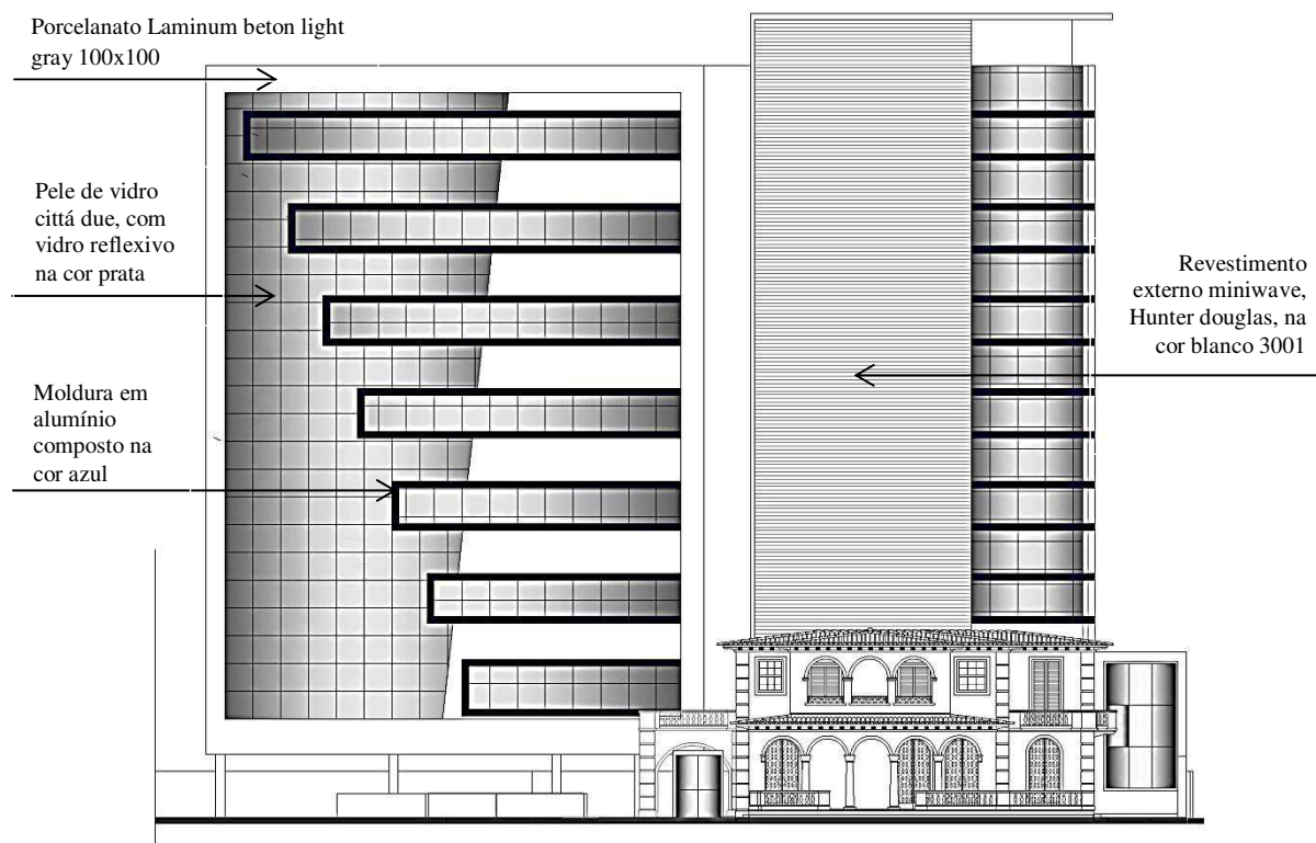
Figura 104- Vista Frontal do Centro Médico de Diagnóstico e Oncologia.
