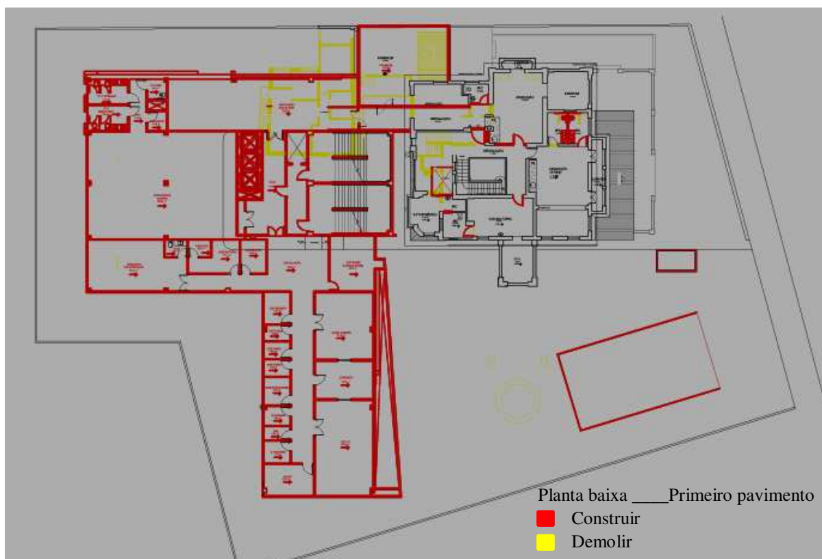
Figura 103- Planta baixa 1º Pavimento - Construir/ Demolir.
