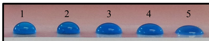
Figura 33. Teste do colapso da gota utilizando os sobrenadantes livres de células das amostras de: 1) Controle (meio de cultura estéril e não inoculado); 2) Pseudomonas fluorescens BMA-05; 3) Enterobacter aerogenes BMA-10; 4) Klebsiella oxytoca BMA-13 e 5) Bacillus pumilus BLD-07. A solução de azul de metileno foi acrescentada ao sobrenadante para melhor visualização do colapso da gota. O teste foi realizado em triplicata.
