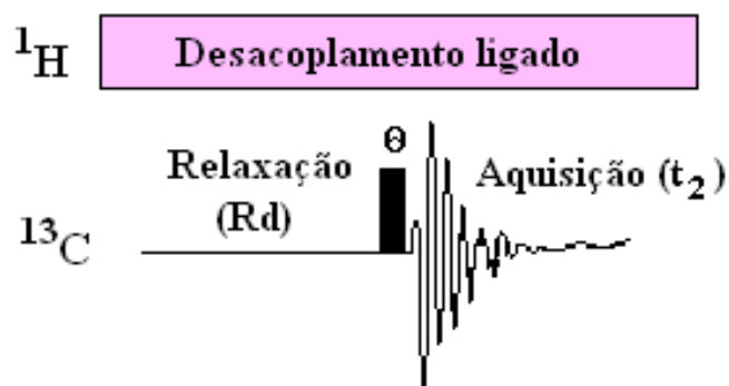
Figura 20 - Sequência padrão de pulsos para o desacoplamento de hidrogênio no espectro de ^{13}\text{C} . R_d é o tempo de espera para relaxação; \theta é o ângulo variável de pulso e t_2 é o tempo de aquisição do sinal.
