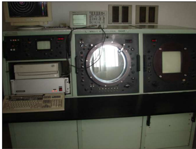
Figura 10 – Painel de controle e visualização analógica do sinal do radar. À esquerda, em baixo, módulo de digitalização do SASSANDRA
