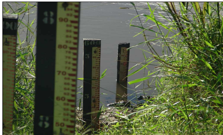
Figura 4 – Conjunto de réguas limnimétricas da Estação da Fazenda Boa Fortuna
