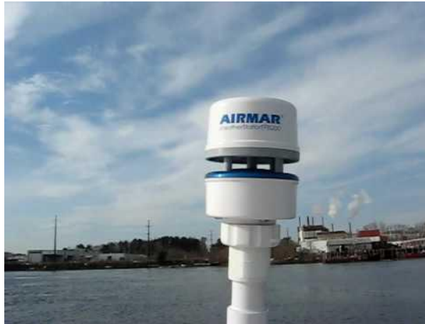
Figura 15: Estação meteorológica fixada na haste da embarcação.
