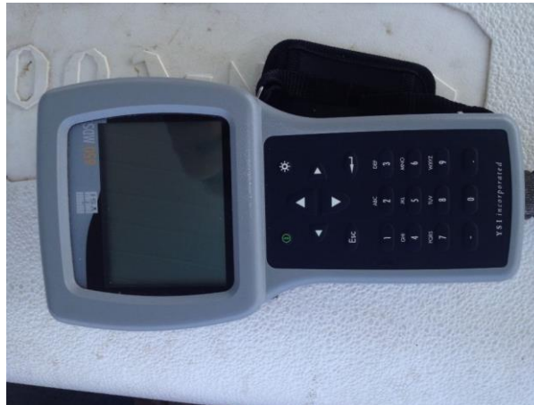
Figura 10: Display YSI acoplado a sonda multiparamétrica.
