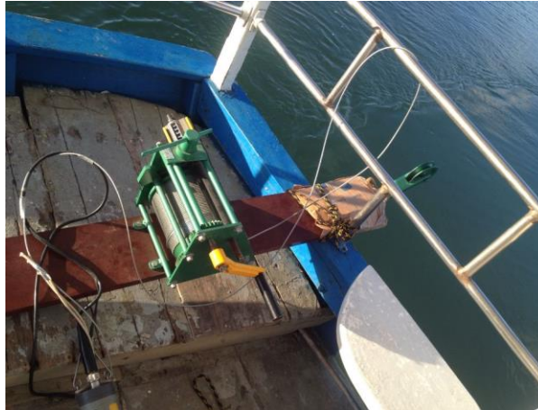
Figura 9: Guincho manual utilizado para descer a sonda multiparamétrica.
