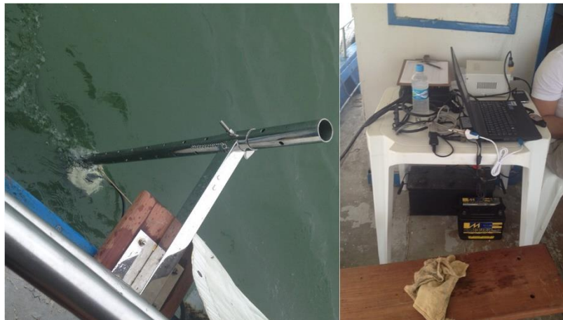
Figura 12: ADCP sincronizado com notebook para avaliação das amostras.
