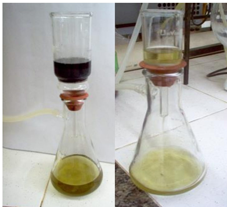
Figura 8: Separação do ácido graxo e o carvão ativado, com o auxílio de um funil sintetizado.
