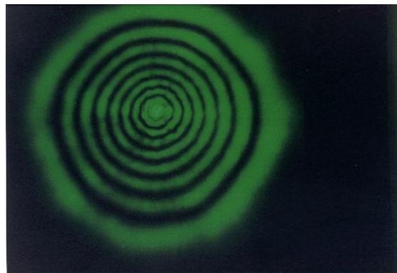
Figura 3.3: Fenômeno de auto-modulação de fase de um feixe ao se propagar em uma amostra líquido-cristalina.
