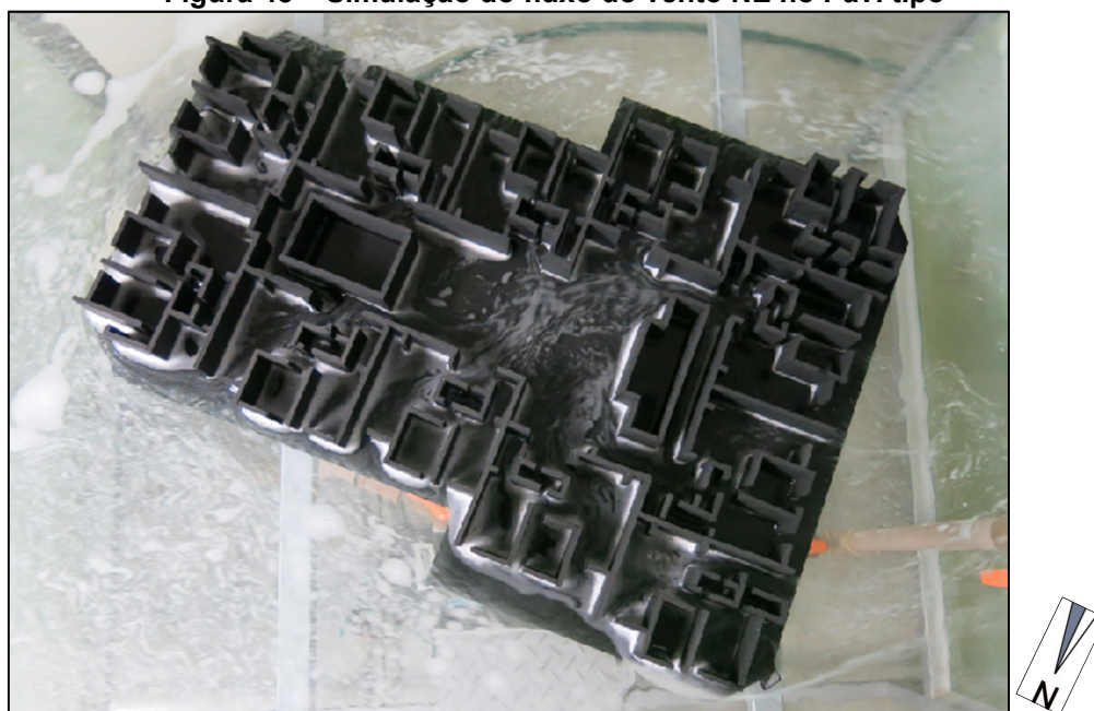
Figura 48 – Simulação do fluxo do vento NE no Pav. tipo
