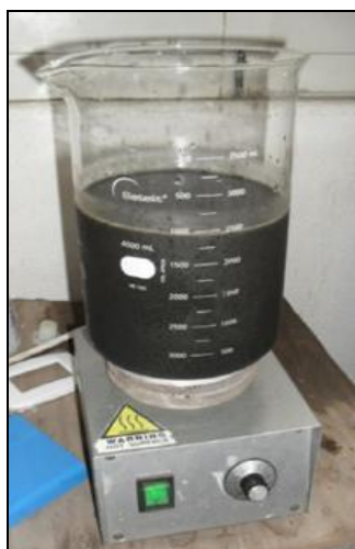
Figura 6 – Realização do tratamento térmico do lodo utilizado no experimento
