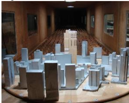
Figura 1.15 – Simulação no Túnel de vento.
