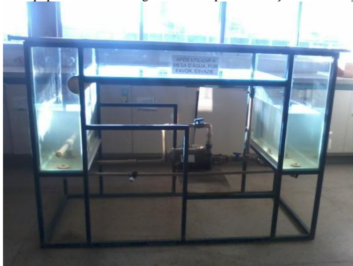
Figura 1.16 - Equipamento mesa d'água utilizado para simulação da ventilação natural.
