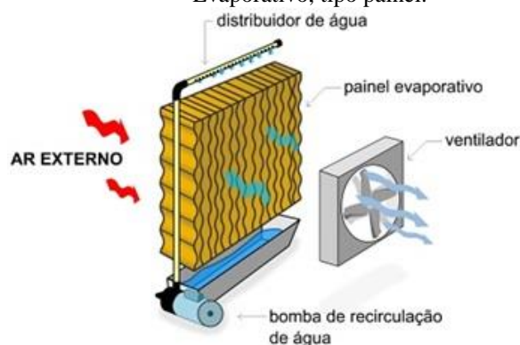
Figura 1.11 - Funcionamento e principais componentes de sistemas de Resfriamento Evaporativo, tipo painel.
