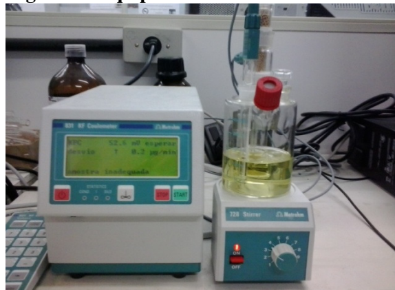
Figura 7 - Equipamento Karl Fisher
