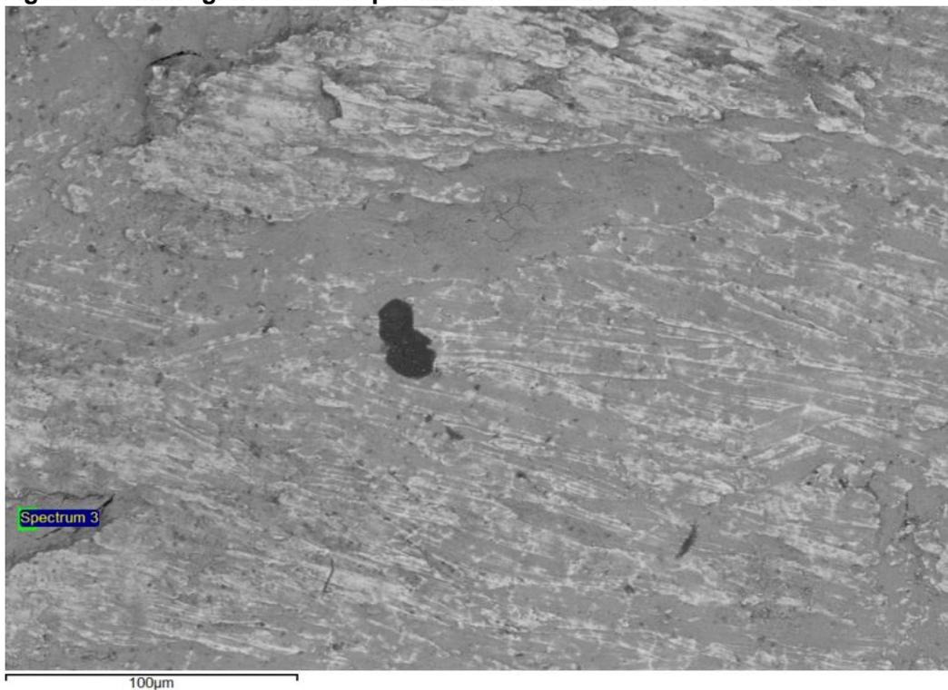
Através da técnica de MEV foi possível analisar que o catalisador 100% ferro, possui uma estrutura mais uniforme em sua superfície. Nas análises de EDX não foi detectada a presença de  $\text{TiO}_2$ .
