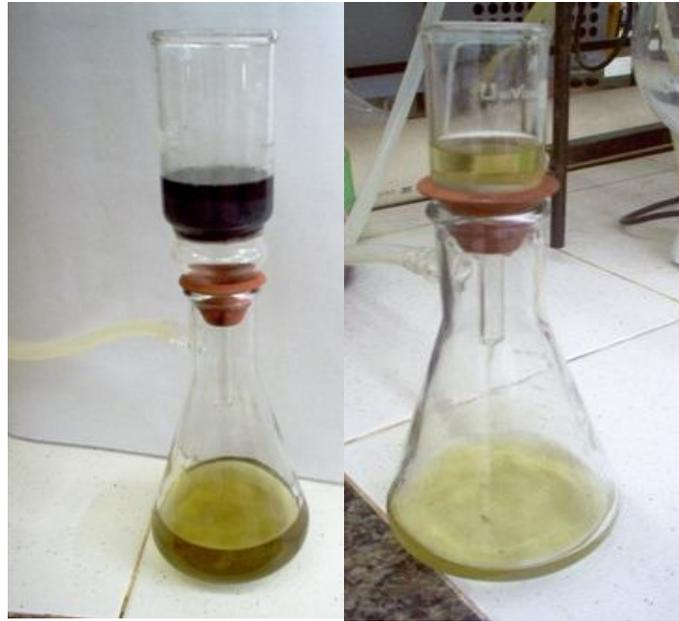
**Figura 40:** Separação do ácido graxo e o carvão ativado, com o auxílio de um funil sinterizado.
