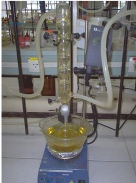
**Figura 19:** Sistema de condensação utilizado para as reações de transesterificação
