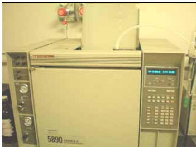
**Figura 10.** Cromatógrafo Gasoso utilizado nas análises.
