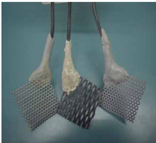
Figura 8 – Aço inoxidável 316 – Montagem final
