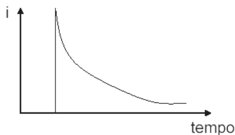
Figura 9: Resposta da corrente em função do tempo na cronoamperometria.
