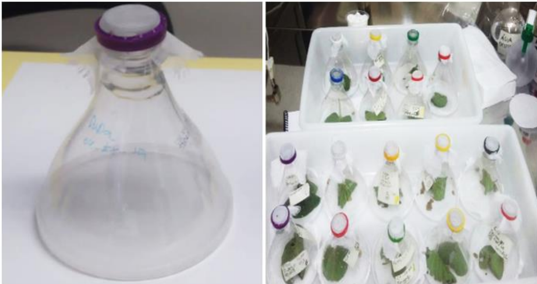
Figura 3 – Gaiola-bernadete (~ 300 mL) (LIMA E CARVALHO, 2017) utilizada para a criação de larvas e adultos de Zatrephina meticulosa Spaeth, 1909 (Coleoptera: Chrysomelidae: Cassidinae: Mesomphaliini) alimentados com folhas frescas de Ipomoea pes-caprae (L.) R.Br. (Convolvulaceae), importante planta alimentícia para espécies de Cassidinae (Coleoptera: Chrysomelidae).
