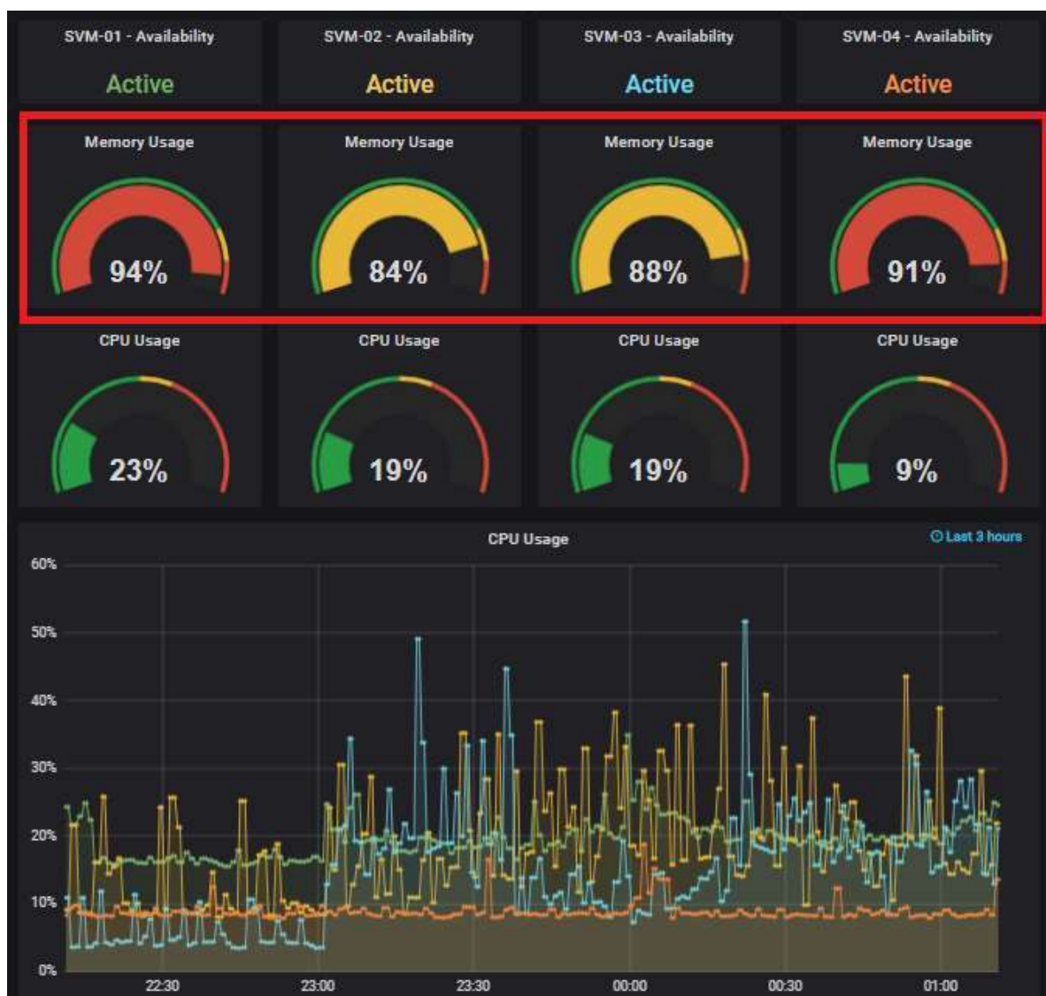
Figura 31 - Memória RAM dos servidores de virtualização próxima do colapso
