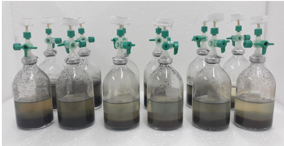
Figura 3 - Reatores usados na digestão anaeróbia.
