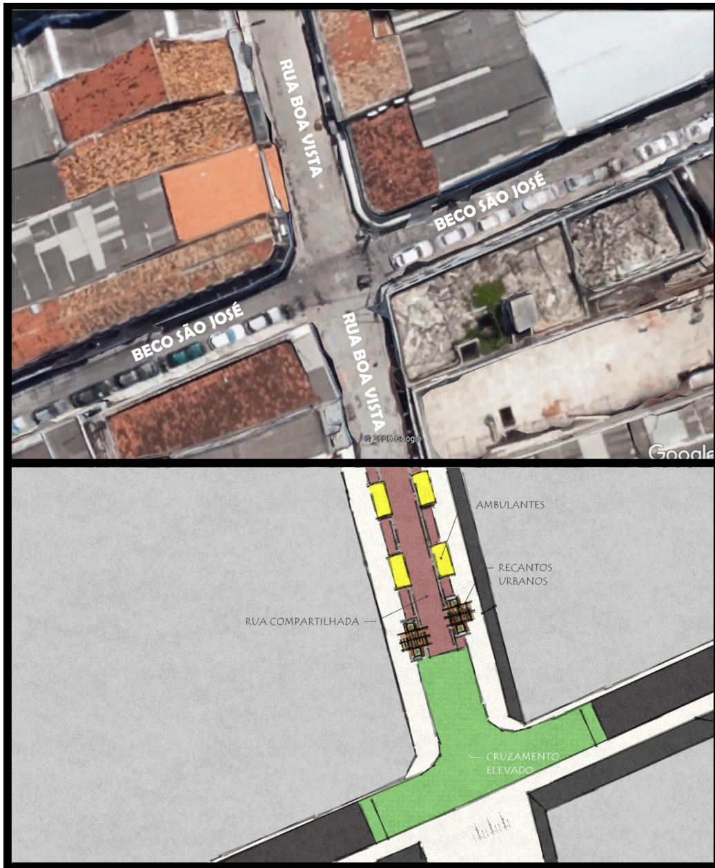
Figura 36 - Esquema de intervenção no cruzamento do Beco São José com a Rua Boa vista
