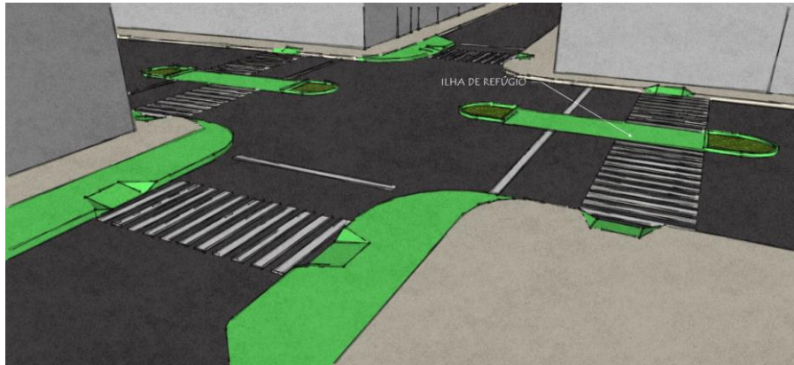
Figura 33 - Croqui de ilhas de refúgio no cruzamento da Rua do sol com a Rua Melo Morais
