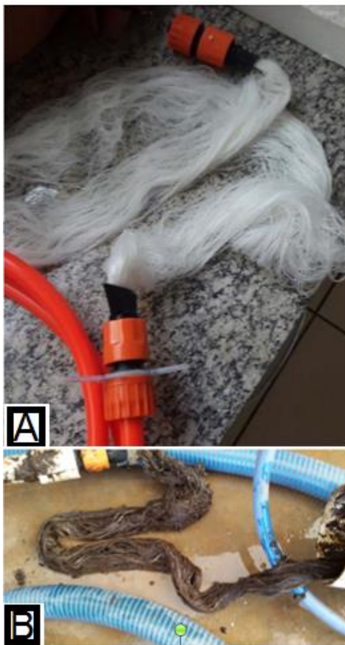
Figura 9. (A) Membranas de silicone do tipo fibra oca (B) MABR após o experimento
