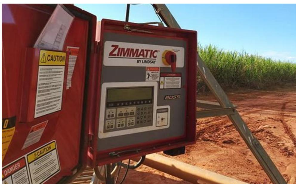
Pivot Control, uma máquina que auxilia a usina canavieira no gerenciamento eficiente dos pivôs de irrigação. Retirado de: [www.revistarural.com.br](http://www.revistarural.com.br)
