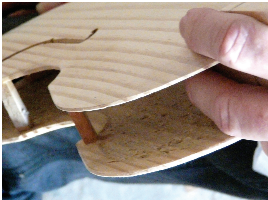
Figura 3. Vigas de Sustentação dos Testos da Rabeca (Foto de Pesquisa)
