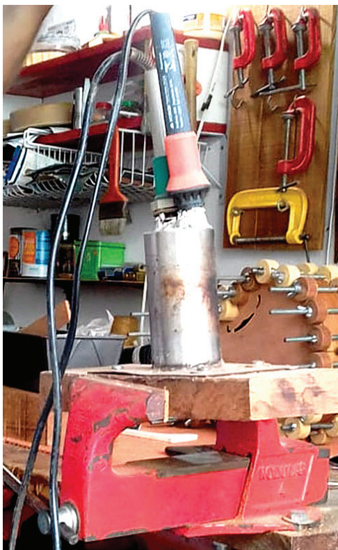
Figura 10. Ferramenta para Curvar Madeira das Laterais (Foto de Pesquisa)
