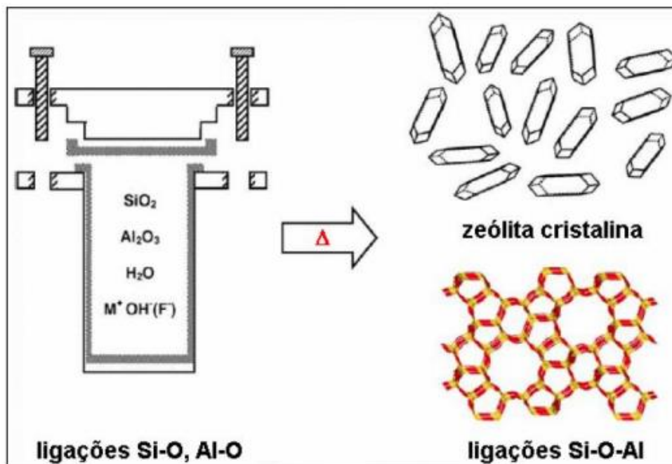
Figura 6 – Esquema da síntese de zeólitas via método hidrotérmal.
