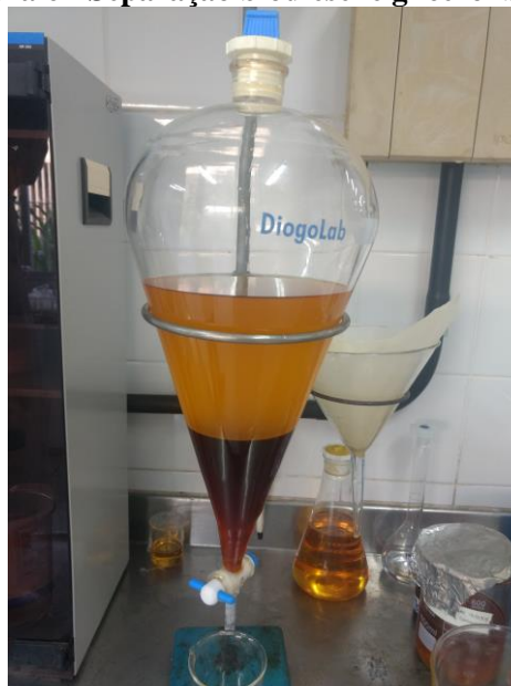
Figura 6 - Separação biodiesel e glicerol bruto.
