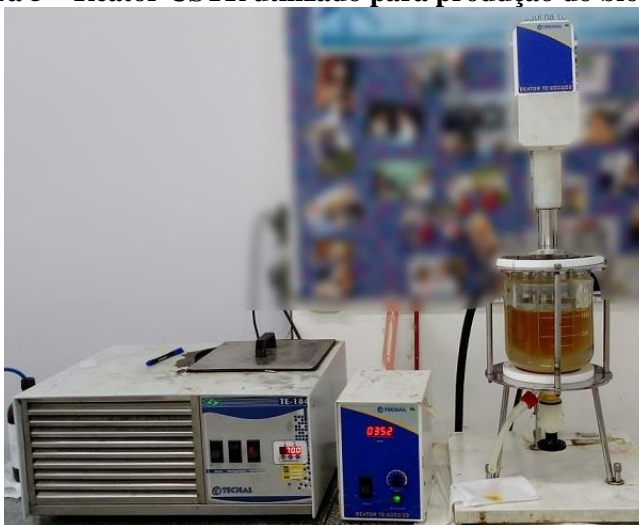
Figura 5 – Reator CSTR utilizado para produção do biodiesel.
