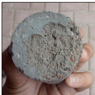
Figura 33 - Esfarelamento superficial, adição de 30% de argila expandida.
