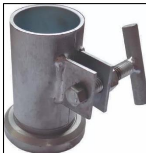
Figura 23 - Molde cilíndrico utilizado na moldagem dos CP's.
