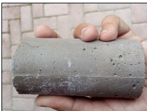
Figura 31 - Fissura em CP's após o aquecimento à 500°C.
