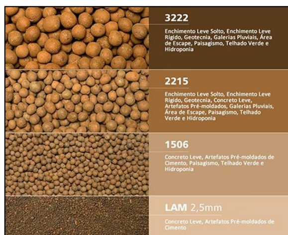
Figura 9 - Granulometria da argila expandida.
