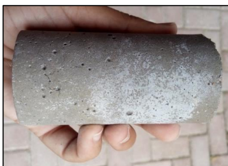
Figura 34 - Fissuras leves, adição de 50% de argila expandida.
