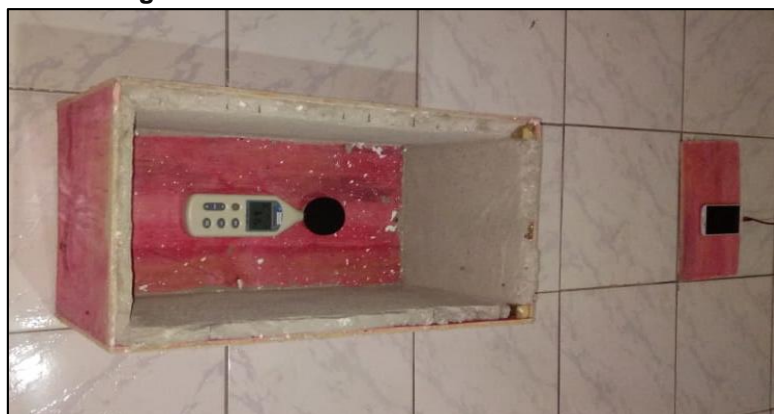
Figura 21 - Posicionamento da fonte de ruído.
