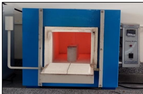
Figura 27 - CP's após serem submetidos 30min a alta temperatura (750°).
