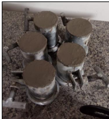
Figura 24 - Preenchimento total do molde cilíndrico.
