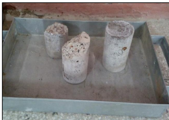
Figura 35 - Corpos de Prova após explosão dentro da mufla.
