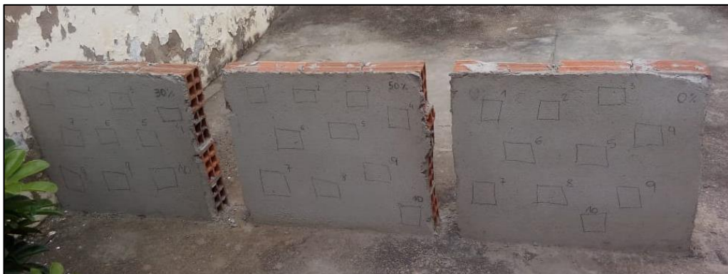
Figura 18 - Demarcação de Pontos.
