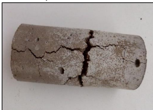
Figura 32 - Trinca profunda nos CP's com 0% de argila.
