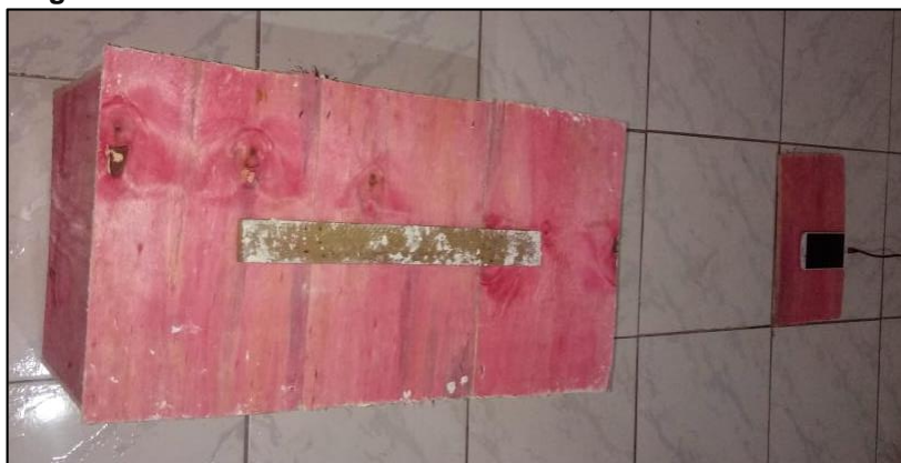
Figura 22 - Caixa fechada e decibelímetro coletando os ruídos.
