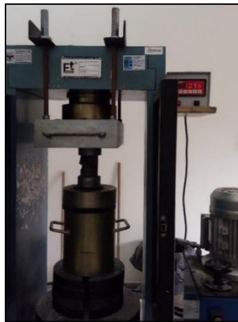
Figura 30 - Rompimento dos CP's.
