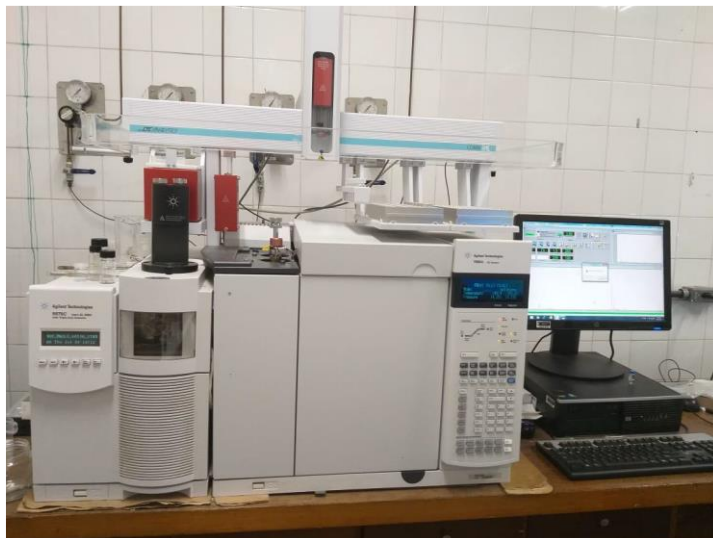
Figura 4- Cromatógrafo gasoso acoplado a espectrômetro de massas.
