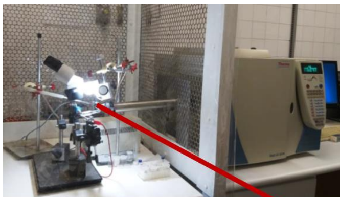
Figura 5- Cromatógrafo gasoso acoplado a eletroantenógrafo
